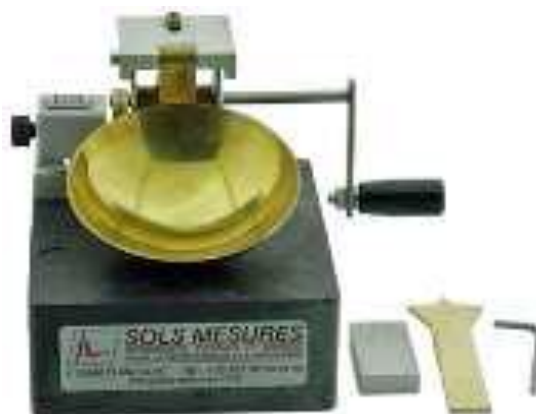
Figura 2.4 - a) Aparelho de Casagrande usado para a determinação do limite de liquidez. Fonte: [18].
